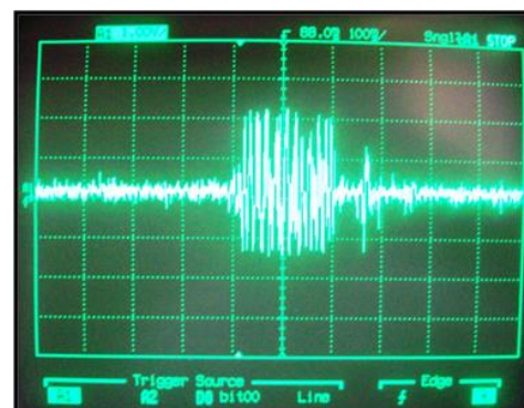
Figura 5. Señal de salida del amplificador LF353. Fuente: El presente estudio
