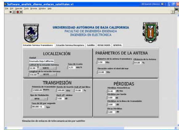
Figura 6) Interfaz de usuario para la sección del Transmisor.
