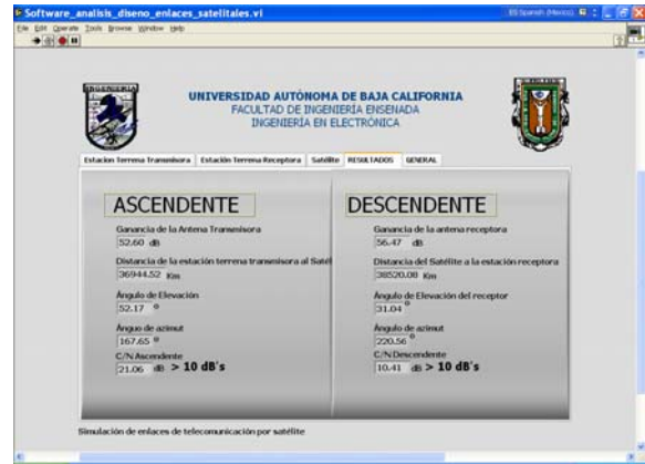
Figura 9) Interfaz gráfica para la sección de resultados (enlace ascendente y descendente).
