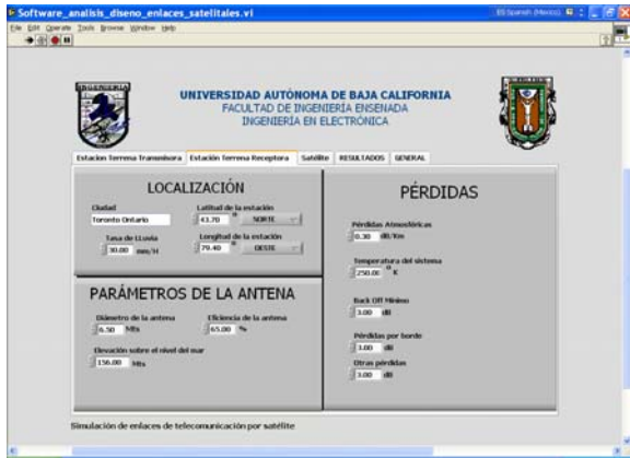
Figura 7) Interfaz de usuario para la sección del Receptor.
