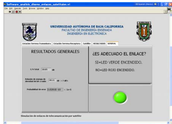
Figura 10) Interfaz gráfica para la sección de resultados generales del enlace.
