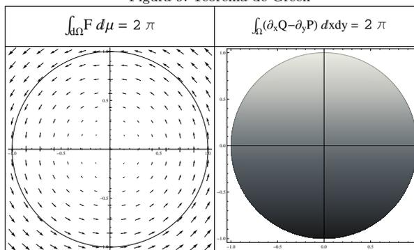
Este mismo procedimiento permite al alumno comprobar la importancia de la orientación cuando se calcula la integral de línea. Por un lado el alumno puede observar como cambia el signo de la integral al cambiar la orientación (figura 10), así como verificar que la misma es cero cuando se aplica a un campo conservativo.
