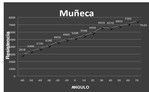
Figura 6. b. Desempeño del sensor, se observa la variación de la resistencia versus el ángulo de giro de la muñeca
