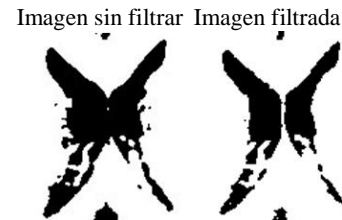
Figura 4. Resultados de la segmentación de Umbral Binario. (a) Segmentación de Imagen original. (b) Segmentación de Imagen filtrada.
