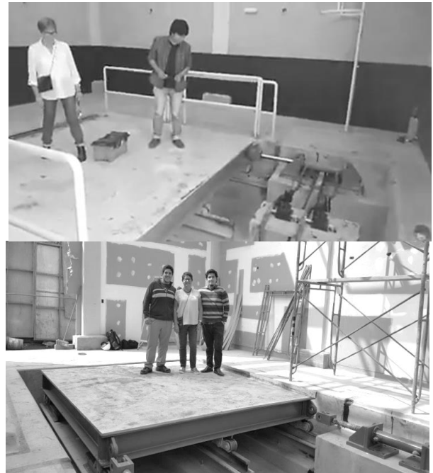
Figura 1. Sistema de Simulación Sísmica, Proyecto INNÓVATE-Perú. Fuente: CECOS-BRIGURP (2018)
