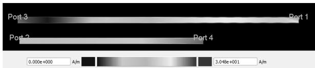
Fig. 7 Simulación de los valores de campo magnético en TL de Tx (1-3) y Rx (2-4).
