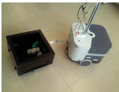
Figura 9. Robot móvil y remolque (tractor virtual)
