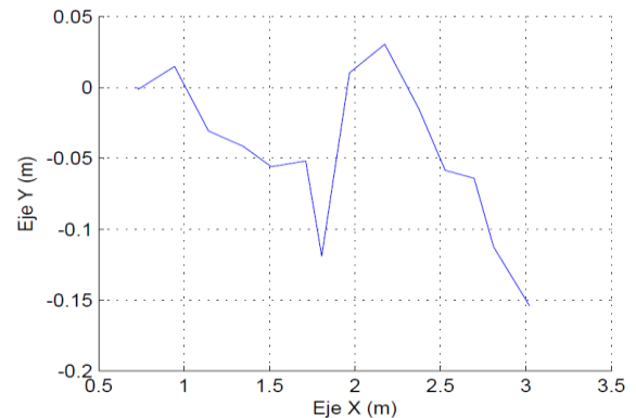
Figura 10. Gráfica de trayectoria del tractor virtual desde un punto inicial (0.73, 0.00)m al punto final (3.00, 0.00)m
