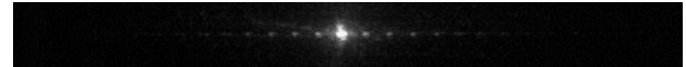
Figura 10. Patrón de difracción producido por 11 líneas grabadas con separación de 100 [μm], con 7 órdenes de difracción.
